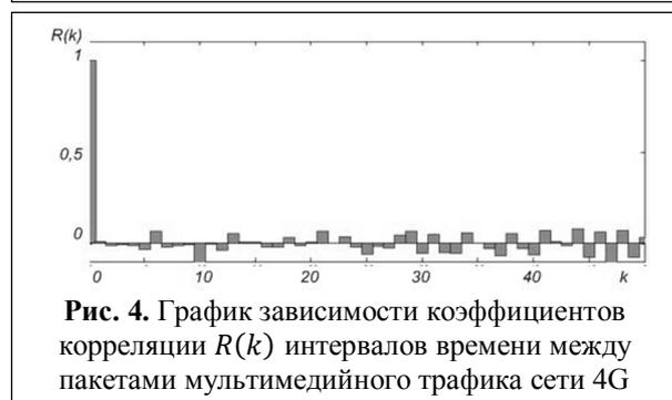
Рис. 4. График зависимости коэффициентов корреляции  $R(k)$  интервалов времени между пакетами мультимедийного трафика сети 4G
