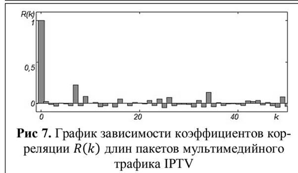
Рис. 7. График зависимости коэффициентов корреляции  $R(k)$  длин пакетов мультимедийного трафика IPTV
